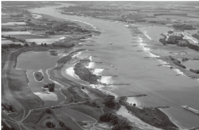
かつての氾濫原の一部であったサイドアーム(旧支流)と川とを再接続し、氾濫原の生態系を再生。Photo by B.Boekhoven,RWS-NL
